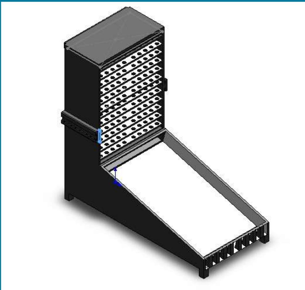
El diseño preliminar del deshidratador solar terminó por satisfacer las necesidades básicas que se deben de tener, como es el paso de aire frío para calentarlo por la parte inferior del deshidratador, pasando por la cabina donde se colocan los productos a deshidratar, finalmente tiene una salida de aire para que el aire caliente tenga una liberación, contando también con el diseño de ensamble entre un deshidratador y otro.
