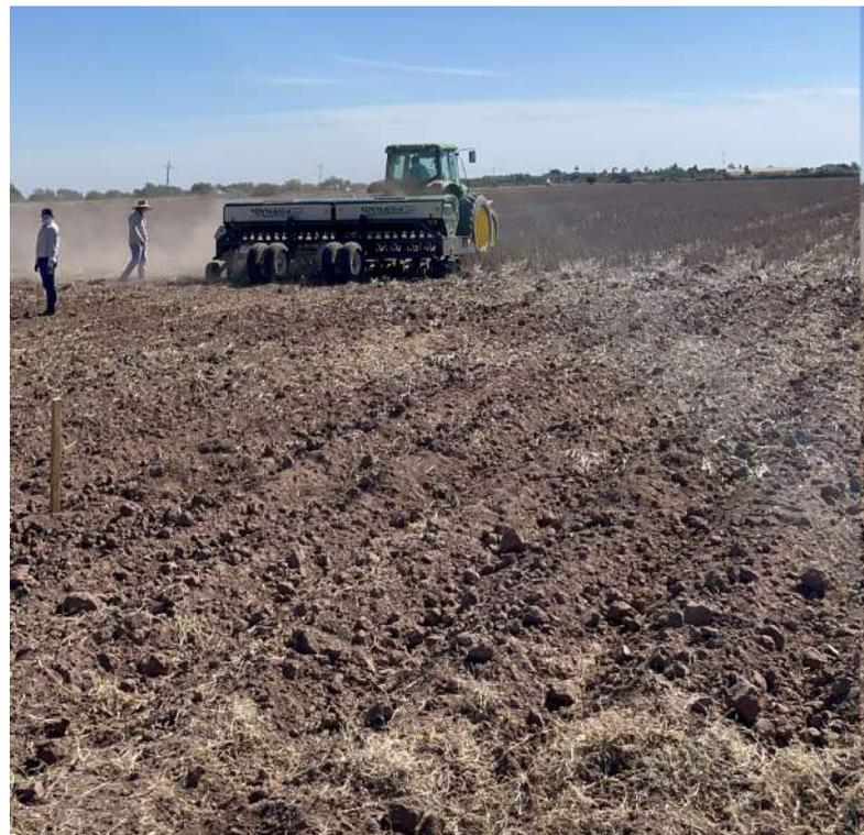
Figura 3. Sembradora especial para agricultura de conservación en la siembra de trigo sobre los residuos de la cosecha anterior, en Huatabampo, Sonora. Fuente: Imagen propia.
